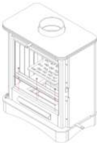
37. Kolejność demontażu oraz wymiany deflektora i wyłożenia accumotte – VEGA The procedure for the baffle and Accumotte lining disassembly and replacement – VEGA
