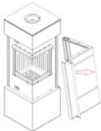
21. Kolejność demontażu oraz wymiany deflektora i wyłożenia accumotte – THOR The procedure for the baffle and Accumotte lining disassembly and replacement – THOR
