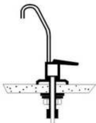
FIGUR 10. Montering av kranen i bänken
