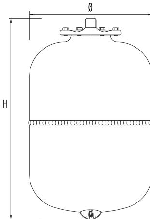
Vaso d'espansione con membrana intercambiabile per circuiti chiusi di riscaldamento.
