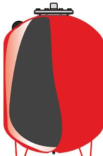
Il volume dell'acqua continua ad aumentare sino a quando, raggiunta la temperatura massima, la membrana occupa la quasi totalità del volume del vaso. La presenza della membrana evita qualsiasi contatto tra l'acqua e la superficie interna del vaso.
