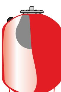
Gradualmente la temperatura dell'impianto inizia a scendere e con essa il volume dell'acqua, il vaso cede ora l'acqua all'impianto grazie alla pressione dell'aria della camera presurizzata sino al raggiungimento del volume iniziale ed il ciclo si riavvia.
