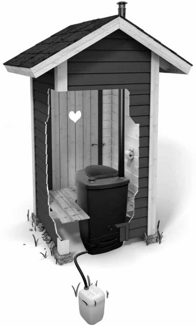
Esimerkkikuva käymälän asennuksesta ja nesteenoistokanisterin sijoituksesta.
