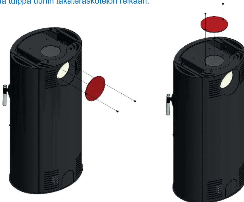
4. Odkręcić zaślepkę wylotu spalin z tyłu korpusu paleniska.
