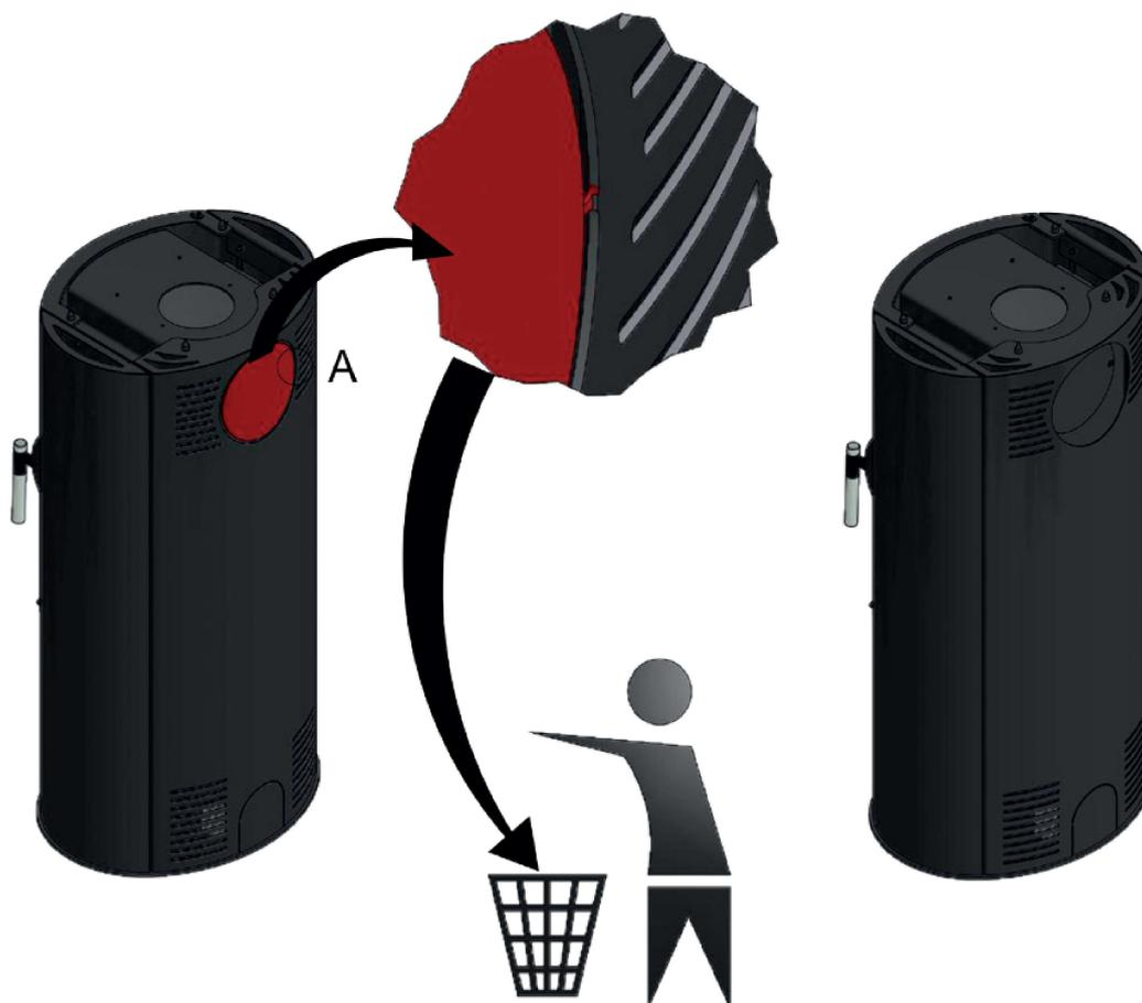
3. Wyciąć zaślepkę otworu w tylnej stalowej obudowie pieca.
