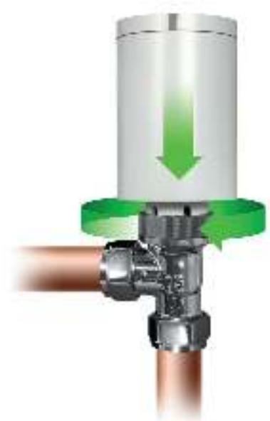
Paina uusi venttiili sisään ja kiristä myötäpäivään.
