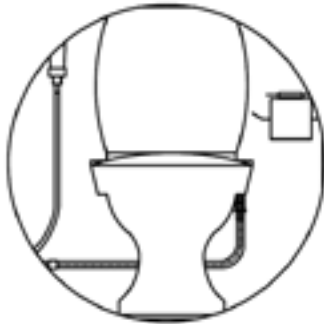
WC-istuimen kytkentä Uponor-kytkentäliitin 16 x 10 (1007653)
