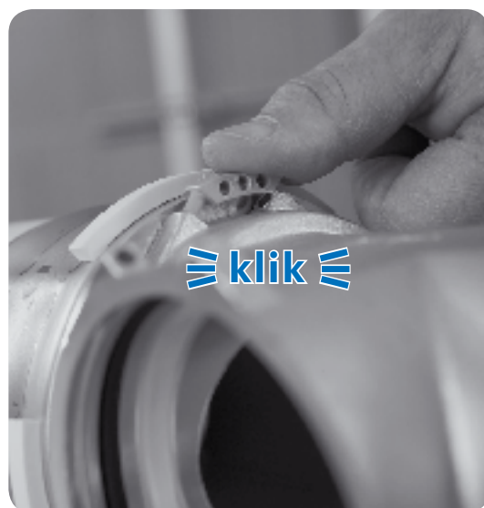
Kuva 5. Varmista, että lukitussokka on painettu pohjaan saakka.
